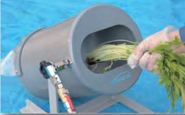
冷たい水で、手で擦りあわせながら綺麗に洗う根菜。ベジピカを利用することで、手に水に直接触れず高圧水流で汚れを落とすことが可能です。
