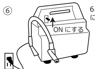
6. ミニブーストポンプの電源プラグを、家庭用コンセント (AC100V) に接続し電源を ON にするとミストが発生します。
