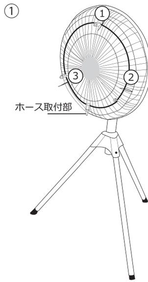
1. ミニブーストポンプ、ミストリング、10m ホース、インシュロックを梱包箱より取り出し、工場扇を安定した地面へ置きます。ミストリングをインシュロックで3箇所工場扇に固定します。この時、ホース取付部が必ず左図①のように工場扇の下側にくるようにしてください。
