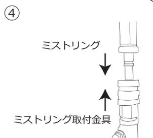
4. ミニブーストポンプに付属の黒色高圧ホース先端部をミストリングに接続します。
