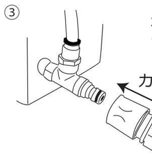
3. 10m ホースの反対側をミニブーストポンプの取付金具に取付けます。この時、ワンタッチ継手がカチッと音がするまでしっかりと差し込んでください。
