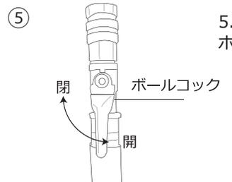
5. 蛇口を開き、黒色高圧ホース先端部のボールコックを左図のようにホースと平行になるように回します。
