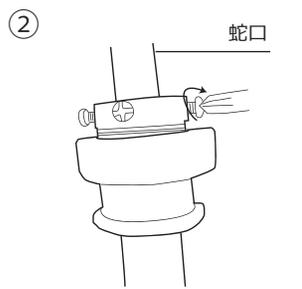
2. 10m ホースを蛇口 (散水栓) に取付けます。左図②のように10m ホースのネジが付いている側をネジ4点で蛇口に固定します。
